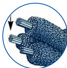
DETALHE DO FILAMENTO E CONSTRUÇÃO DA LINHA CORRENTE DUO GLACE
