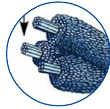
DETALHE DO FILAMENTO E CONSTRUÇÃO DA LINHA CORRENTE POLI POLI
